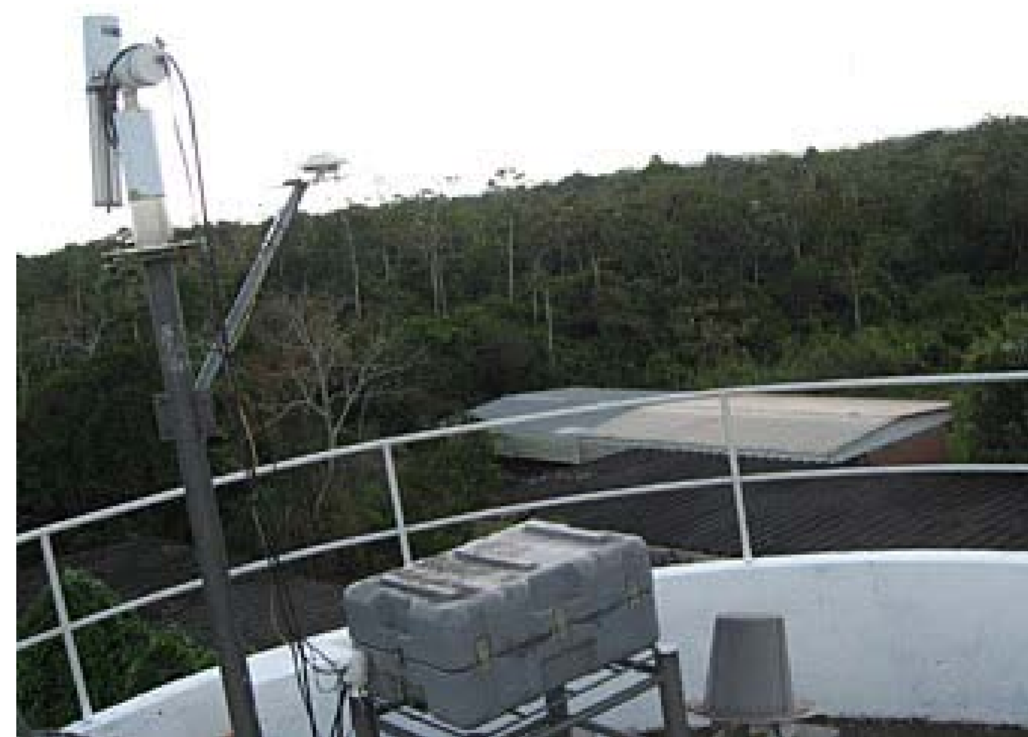
Figura 1. Estação fotométrica, onde se realiza o monitoramento da intensidade da radiação solar.
