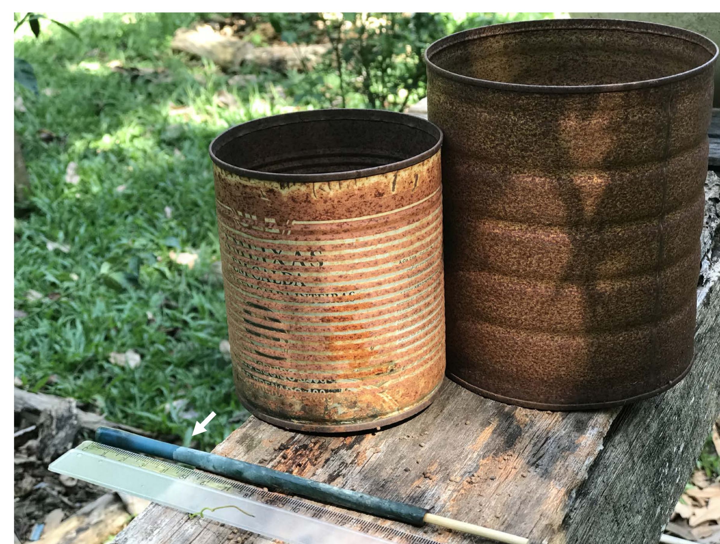
Figura 2. Pluviômetros de diâmetros 10 e 12,8 cm e a medição de uma chuva de 39 mm. A seta mostra o nível da água.
