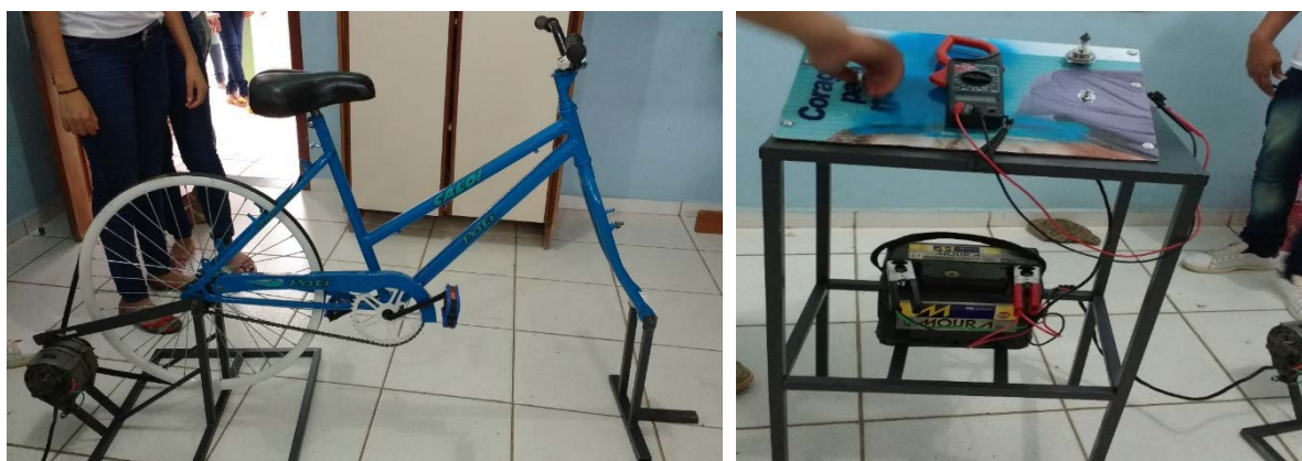
Foto 4 – Bicicleta geradora de energia elétrica e seu painel do circuito elétrico. Fonte: Elaborado pelos autores, 2016.
