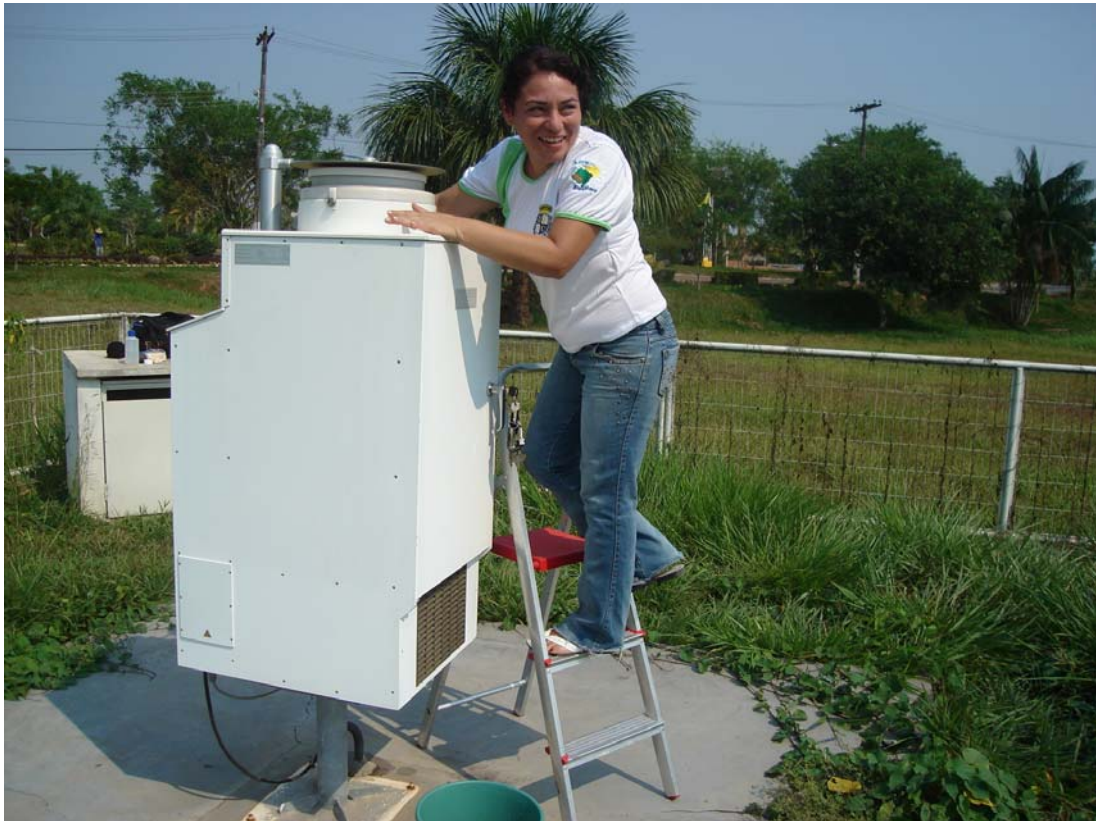
Figura 2. Limpeza da parte externa do amostrador de chuvas.
