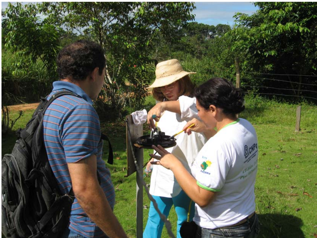
Figura 5. Limpeza de um pluviômetro numa outra área de experimentação.
